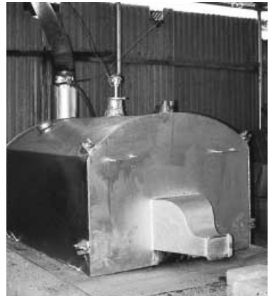
그림 4-3-10. 개량탄화로 모식도 및 실물 사진
