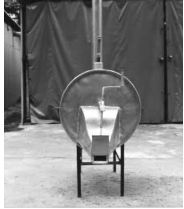
그림 4-3-9. 간이탄화로 모식도 및 실물 사진
